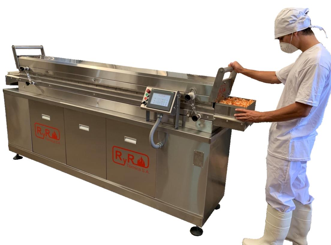
Los deshidratadores modelo EcoDry combinan la calidad de los productos terminados deshidratados con el bajo costo operativo. Diseñados para uso intensivo en plantas piloto y pequeñas industrias. El rango de carga es de 50 a 100 kg / día según el producto y/o la humedad final requerida.
